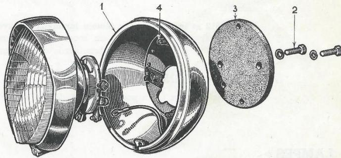
Le 641/1364 est réglable grâce à une semelle en caoutchouc souple (3) qui, en même temps, forme joint. Le réglage est obtenu par deux vis pointeau (4) prenant appui sur la nervure de l'aile.
